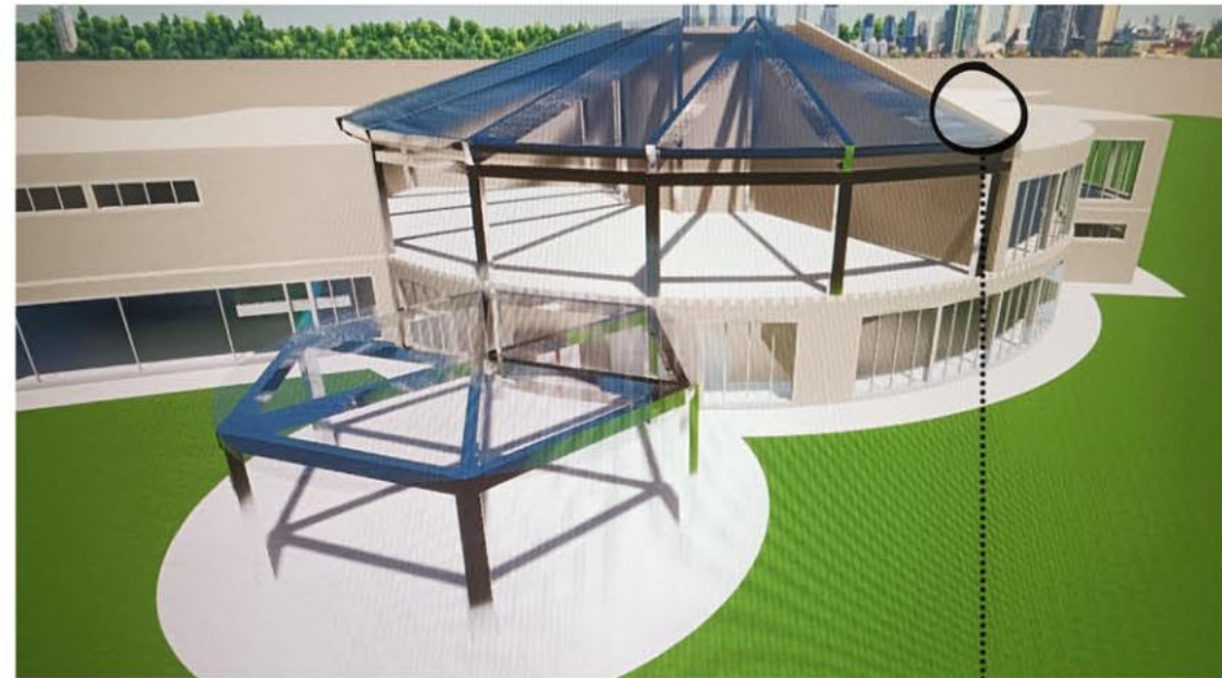
COPERTURA IN PANNELLI FOTOVOLTAICI TRASPARENTI
